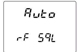
SSB/CWモード時はRFゲインツマミ、FMモード時は、SQLツマミとして動作する
